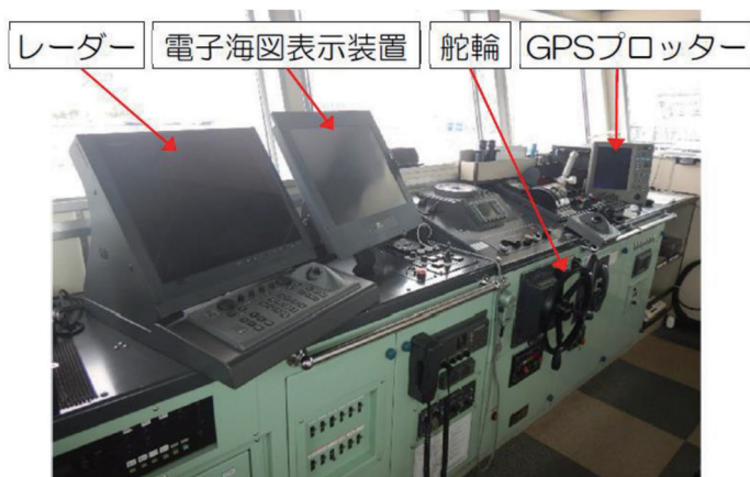
【写真 2-1 船橋内の航海計器の配置】
