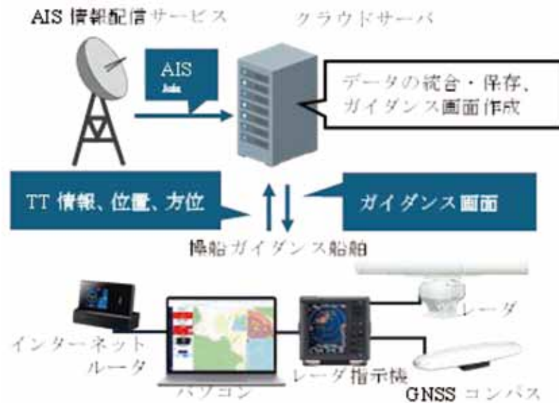
図12 航行監視システム機器構成
