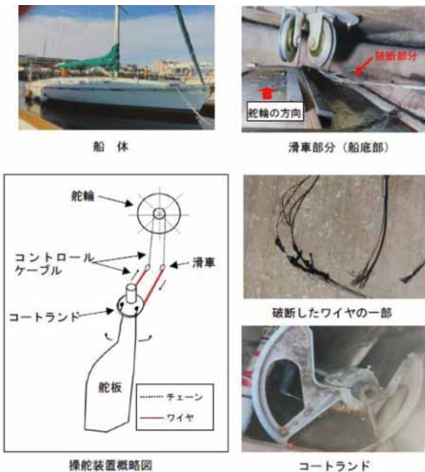
図 2-11 本船及び損傷箇所等
