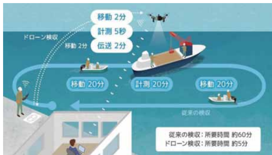
図5 従来検収と開発した船舶石材量検収システムの比較
