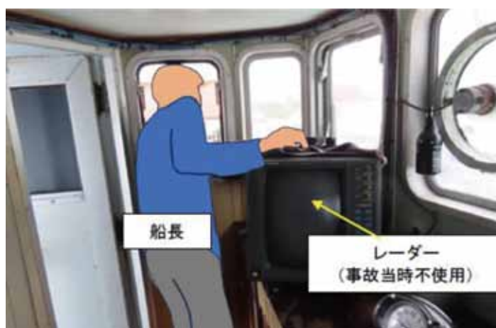
図 2-5 船長が左舷側船窓から頭を出して操船を行う状態
