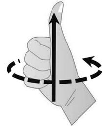
余談ですが、普段、ネジを絞めたり緩めたりするとき、手の向きによっては回す方向が分からず、絞めすぎの原因になったりしませんか。そんな時、右上図のように回転と進行方向を右手で模擬し、確認すれば、妙な体勢でも間違えることは無くなります。くれぐれも左手は使わないようにして下さい。なお、右に回すと締まるのは、多くの人が右利きで、左に回すより力が入り易いため、右ネジが一般化したと言われています。
