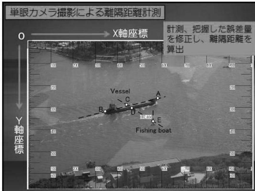
これがモデルのイメージで、そのモデルを計測した上でパソコン画面上に表示させ、座標を使って距離を計測し、実測に置き換えた時の誤差量を出しております。
