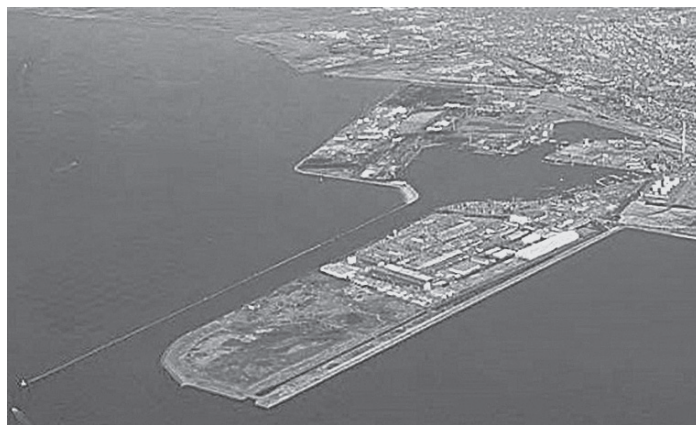
現在の三池港全景(航路の長さ約1830m、奥の細くなったところに明治41年に竣工された水圧式閘門があり干潮でも船渠内の水位を8.5mに保つ。)
