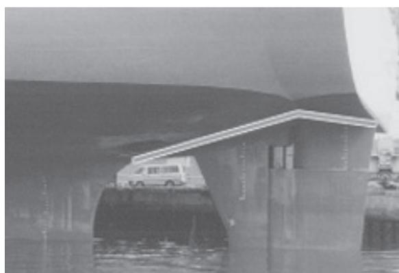
船尾端の船底を折れ曲がった形状として船尾端付近の水流を強制的に下向きにし、船尾端から発生する造波や流れの乱れを抑え、抵抗を減らす。
