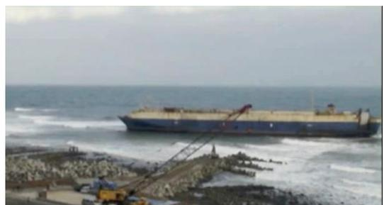
線の一部を埋め立て、チェーンブロー8台を海岸線に設置し、本船を陸岸に引き寄せながら一部を解体し、船体が軽くなれば、また海岸側に引き寄せ、一部を解体することを繰り返し、船体全
